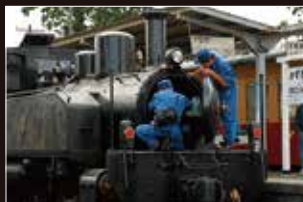
▲煙や蒸気はダミーのため、折り返しの間に発煙装置の液体を補充しています。
