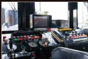
▲DB4形機関車の運転席。新製のディーゼル機関車で、前方カメラのモニターなども備えています。
