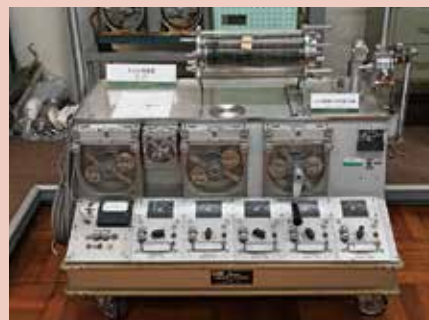
▲人工心臓ポンプ。心臓外科手術時などに患者の心臓の代わりに血液を送り出すポンプの役割を果たします。
