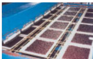
ノリすきから乾燥まで行う全自動のり乾燥機
