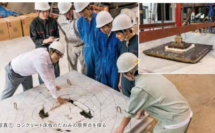
写真① コンクリート床板のたわみの限界点を探る
