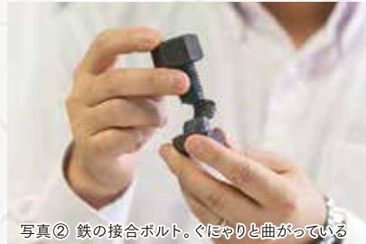
写真② 鉄の接合ボルト。ぐにやりと曲がっている
