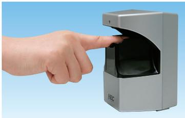
指静脈認証は、手の指の静脈パターンを高度に照合する先進の技術。センサーに指をかざすだけで、正確・スピーディにご本人確認ができます。高いセキュリティと使い易さで、より安全に貸金庫をご利用いただけます。
