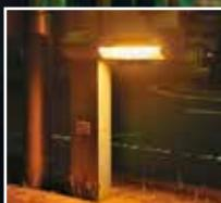
▲2灯式・3灯式のガス灯の下には、歩行者の足元を照らすボーラード灯が設置されています。夜間、ガス灯が消灯してからもボーラード灯の照明は点灯しています。
